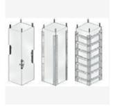
Trattasi del consolidamento di pilastri in c.a. eseguito con applicazione di profili angolari metallici agli spigoli del pilastro mediante tassellatura o applicazione di adesivi speciali. I profili vanno quindi collegati fra loro mediante la saldatura di piastre perimetrali (calastrelli).
